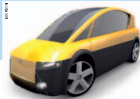
De cito is met een lengte van 3,5 m en een breedte van 1,1 m een stuk kleiner dan een normale personenauto.
