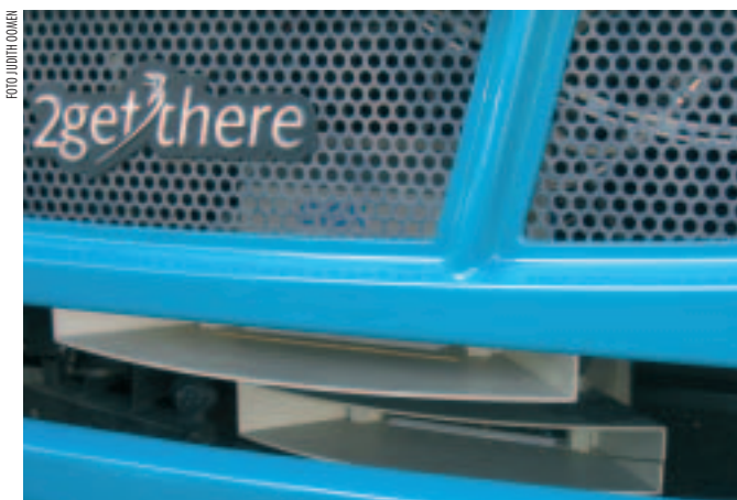
De ParkShuttle beschikt over twee laserscanners om obstakels op de weg te detecteren.
