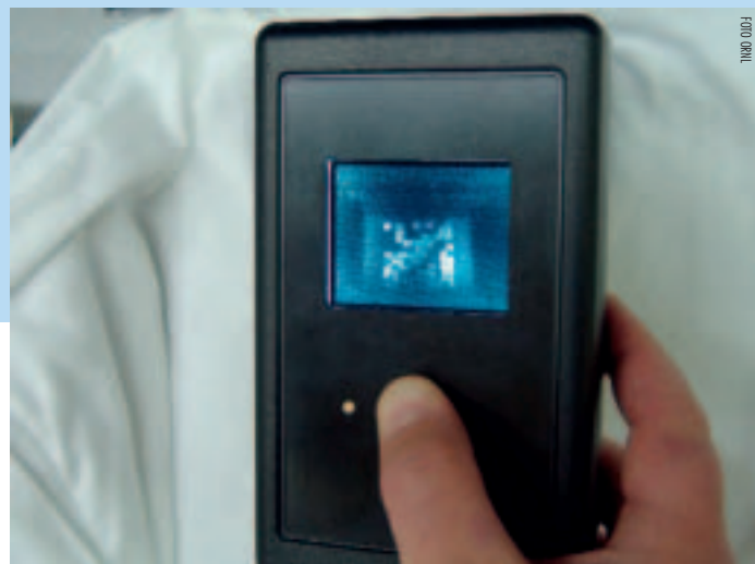
Een speciale scanner die een etiket van fluorescerende verf zichtbaar maakt, kan imitatiemerkkleding aan het licht brengen.
